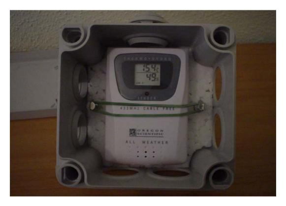
La parte frontal, que queda orientada al Este, en el interior y detrás de la tapa, le he puesto una lámina gruesa de polietileno expandido para minimizar el efecto de la radiación solar de la mañana.
