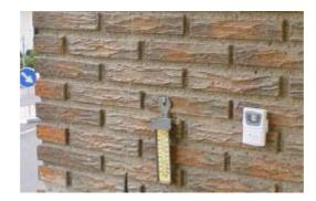
Los núcleos de viviendas generan una isla de calor que afecta a toda el área próxima a ellas incrementando ligeramente la temperatura del aire. Cuando el termómetro se acerca a la pared de la vivienda se ve afectado por el calor residual acumulado durante el día por el edificio y por el calor que escapa del interior de las viviendas.
