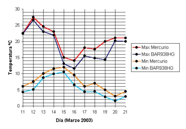
Como conclusión decir que el uso de esta garita ha mejorado de manera sensible los datos obtenidos, manteniendo los valores de temperatura dentro de un rango mas próximo a los reales, aunque el resultado no se puede igualar nunca al de una garita homologada e instalada correctamente. Destacar la pequeñisima inversión de tiempo y dinero necesaria para la fabricación de la garita.
