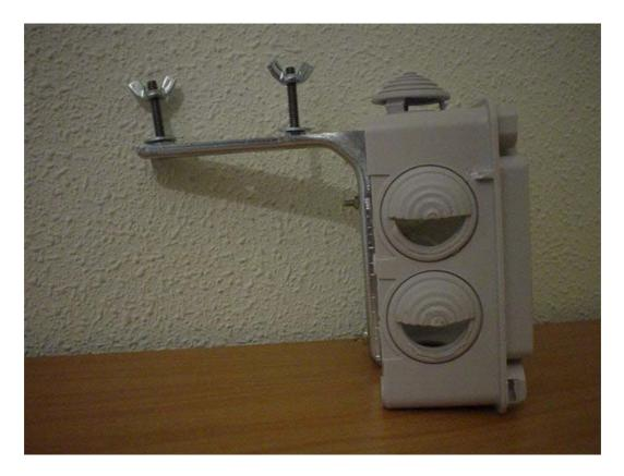
Los dos orificios del lado norte y de la parte inferior de la caja están totalmente abiertos.
