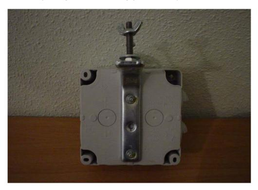
En el fondo de la caja coloqué una fina lámina de polietileno expandido, el "corcho" blanco de los embalajes, para aislar un poco la parte posterior de la caja del calor del edificio.
