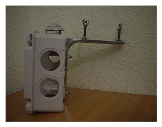
La unidad remota de Oregon Scientific se fija en el interior simplemente mediante una goma elástica a dos tornillos de métrico 3x15 roscados sobre dos pequeños huecos cilíndricos que tiene la caja en el interior.
