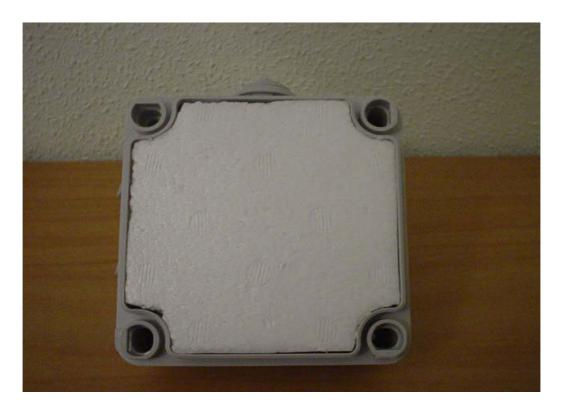
En la parte superior de la caja queda un único orificio donde le he colocado una cumbrera a modo de chimenea para evitar que entre el agua y permitir la circulación de aire caliente hacia el exterior de la caja. He usado un cono de goma que he recortado para hacerle tres patas que he pegado con Loctite a al caja.
